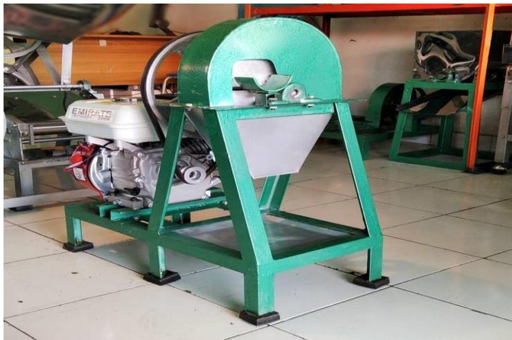
**Gambar 2.5** Mesin Perajang Otomatis
